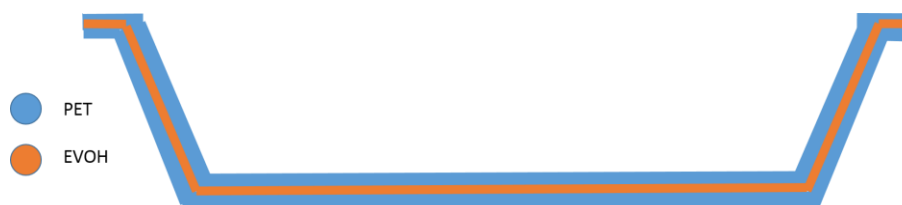
Figuur 3 – Abstracte vereenvoudigde weergave van de doorsnede van een tray van PET-EVOH-PET multi-layer. De EVOH laag ligt tussen twee lagen PET-kunststof in en zorgt voor een gasbarrière.
