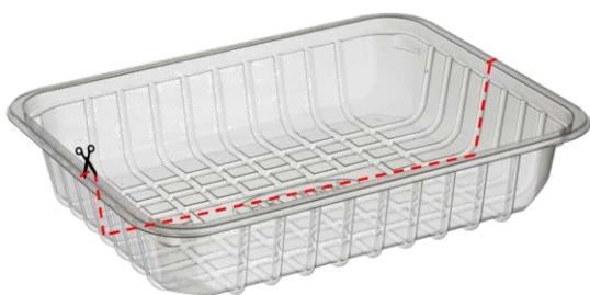
Figuur 1 - Doorsnede lijn van een PET-tray. De volgende figuren zijn een doorsnede van de tray volgens bovenstaande lijn.
